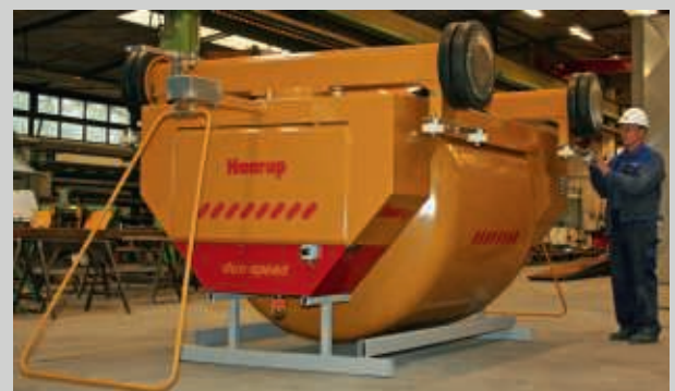
3500 Liter duo-speed Kübelwagen wird vor Lieferung geprüft.
