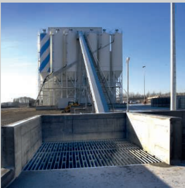
Kippsilo mit fahrbarem Gitterrost
