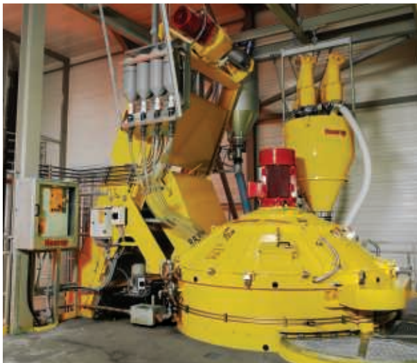
4-Kammer Zusatzmittelwaage über einem 2250 Liter Mischer.
