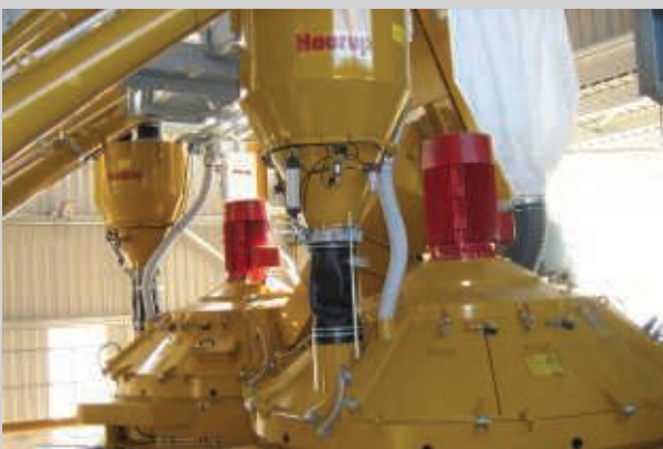
Zementwaagen aufgehängt in elektronischen Wiegezellen.
