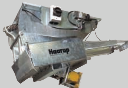
Kombinierter Dosierschieber für große Mengen sowie Vibrationsrinne zur Feindosierung.
