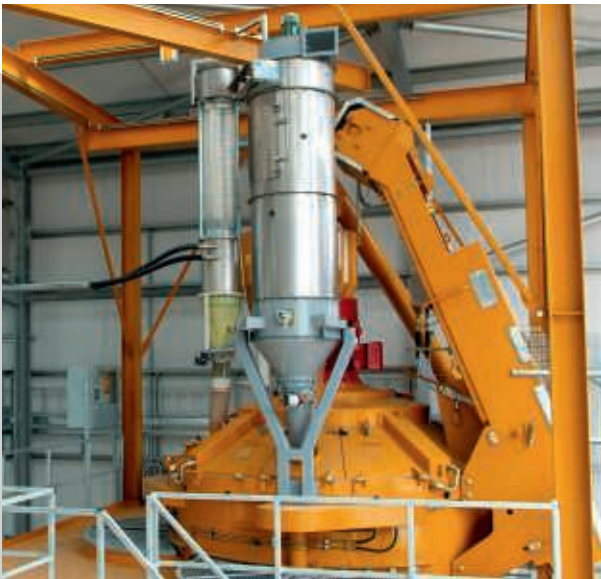
Staubabsaugung auf dem Mischer.
