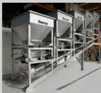
Kleine Dosier- und Mischanlage für Teknologisk Institut.
