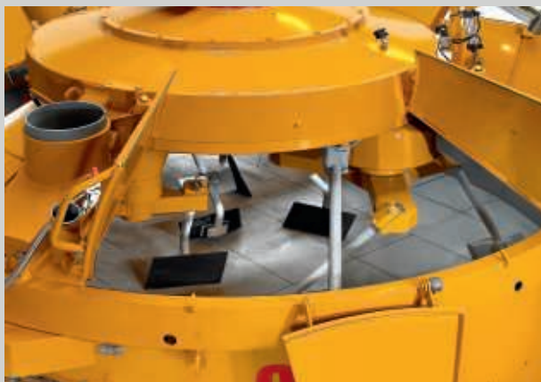
Seitenabstreifer, Mischerarme und Mischschaufeln in einem 6000 Liter Mischer.
