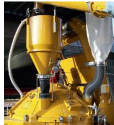
Airbag zur Minimierung des Staubaustritts.
