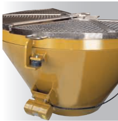
Auslauftrichter mit Rüttler, aufgehängt in Vibrationsdämpfern.
