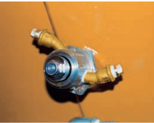
Waagerechte Spüldüse für die Reinigung des oberen Teils des Getriebekastens sowie der Mischarme.
