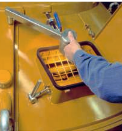
Lampe zur Inspektion des Mischprozesses.
